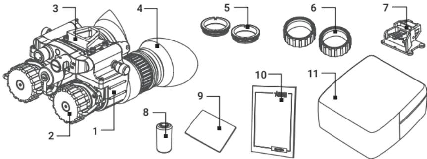
FIGURE 1-2. NVG-40/NVG-50 STANDARD COMPONENTS
