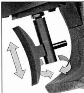
Po uvolnění matice 28 klíčem 73 můžete spoušť otáčet kolem osy čepu převodové páky 21 a rovněž zašroubovávat či vyšroubovávat tento čep a tím posouvat spoušť nahoru nebo dolů ve směru kolmém na osu hlavně. Pro výškové nastavení nejprve uvolníte a vymontujete spoušť z čepu převodové páky (podle předchozího odstavce).
