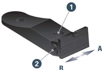
**Ajuste en altura:** Si el punto de impacto es demasiado alto: Gire el tornillo **1** en dirección a las manecillas del reloj. Si el punto de impacto es demasiado bajo: Gire el tornillo **1** en dirección contraria a las manecillas del reloj.
