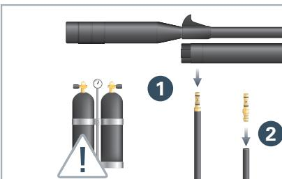
4. **Tauchflaschen:** Lassen Sie den Druck vorsichtig und vollständig aus dem Schlauch entweichen, bevor Sie den Quickfill-Adapter von der Pistole entfernen. Entfernen Sie den Quickfill-Adapter von Ihrer Pistole **1** und dem Füll-Equipment **2**. Zum Entspannen, zielen Sie auf ein sicheres Ziel und betätigen den Abzug.
