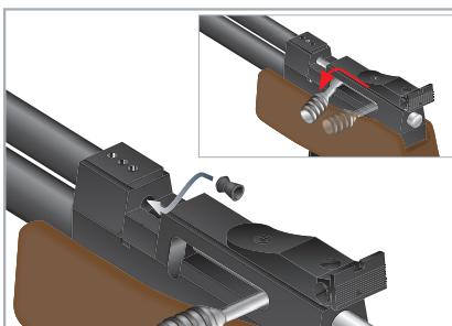
2. Setzen Sie wie abgebildet ein Diabolo bündig in den Lauf und schieben Sie den Spannhebel nach vorne und unten. Laden Sie **nie** mehr als 1 Diabolo in den Lauf.
