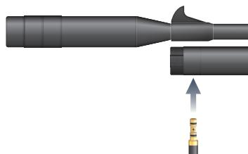
2. Stellen Sie sicher, dass alle Komponenten frei von Schmutz sind. Schieben Sie den Quickfill-Adapter in das Füllventil. Starten Sie das Befüllen. Wenn Sie eine Tauchflasche verwenden, befüllen Sie **langsam**, um eine Hitzebildung zu vermeiden.
