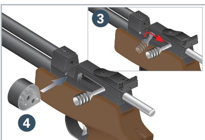
8. Ziehen Sie den Spannhebel hoch und bis zum Einrasten zurück **3**. Setzen Sie wie abgebildet das Magazin ein **4**.
