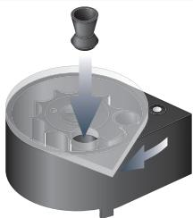
6. Tournez la plaque transparente dans le sens des aiguilles d'une montre jusqu'à ce que la chambre suivante soit visible et introduisez un diabolo
