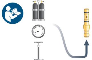
1. Lisez toutes les informations relatives aux caractéristiques techniques ainsi qu'au maniement de votre équipement de remplissage. Veillez à ce que celui-ci soit doté d'un indicateur de pression (manomètre). Connectez maintenant votre adaptateur QuickFill.
