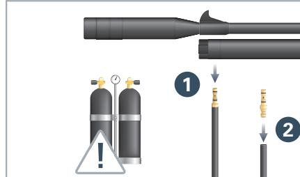
4. **Tanques de submarinismo:** Antes de quitar el adaptador Quickfill de la pistola, libere (purge) completamente la presión de la manguera de llenado. Proceda con precaución para evitar posibles latigazos de la manguera y para así prevenir el riesgo de lesiones. Quite el adaptador Quickfill de la pistola **1** y del equipo de llenado **2**. Para desamartillar, apunte hacia un blanco seguro, pues presione el gatillo.
