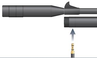
2. Compruebe que ambas conexiones están limpias. Empuje el adaptador Quickfill en la válvula de llenado. En caso de utilizar un tanque de submarinismo (tanque Scuba), proceda lentamente para evitar la generación de calor.
