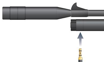
2. Assurez-vous que les éléments de raccord sont exempts de saletés. Insérez l'adaptateur QuickFill dans la vanne de remplissage. Lorsque vous utilisez une bouteille de plongée, remplissez lentement pour éviter une accumulation de chaleur.
