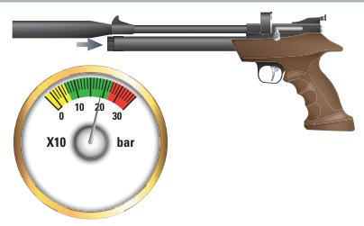
3. Beobachten Sie das Manometer Ihrer Pistole und Füll-Equipments. Wir empfehlen die Kartusche mit 200 bar zu befüllen. **Füllen Sie niemals mehr als 200 bar in die Kartusche!**
