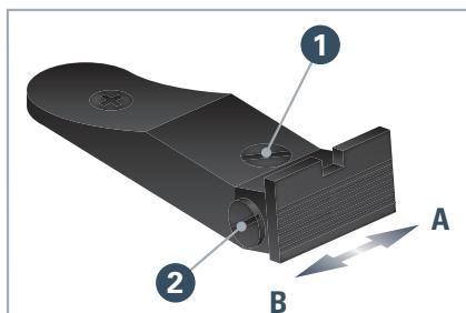
**Réglage en élévation :** Si le point d'impact est trop haut : Tournez la vis **1** dans le sens des aiguilles d'une montre. Si le point d'impact est trop bas : Tournez la vis **1** dans le sens contraire des aiguilles d'une montre.
