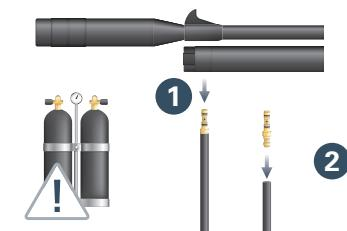
4. **Bouteille de plongée:** Avant d'enlever l'adaptateur QuickFill du pistolet, laisser l'air s'échapper complètement du tuyau de remplissage. Procédez avec précaution pour éviter des éventuels « coups de fouet » du tuyau et donc des blessures pouvant en résulter. Enlevez l'adaptateur QuickFill du pistolet **1** et de l'équipement de remplissage **2**. Pour désarmer le pistolet, visez dans une direction sûre et actionnez la détente.
