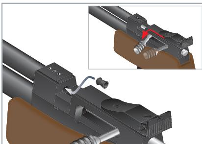
1. Relevez le levier d'armement pour le faire passer dans sa position ouverte et retirez-le jusqu'à ce qu'il s'enclenche **1**. Insérez l'aide de chargement **2**.
