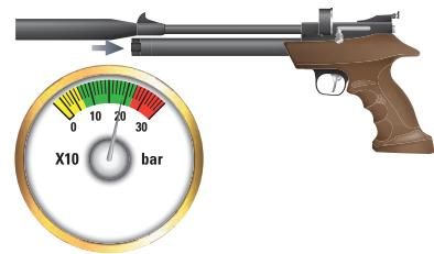
3. Contrôlez l'affichage du manomètre du pistolet et de l'équipement de remplissage. Nous conseillons de remplir la cartouche à une pression de 250 bar. Veillez à ne jamais dépasser une pression de remplissage de 250 bar !
