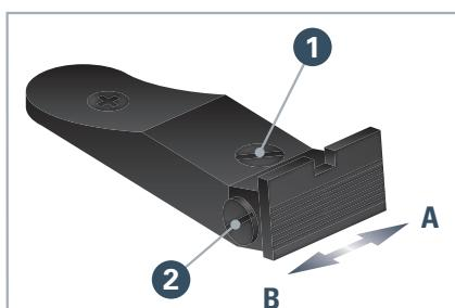
**Höhenverstellung:** Bei Hochschuss: Schraube **1** im Uhrzeigersinn verstellen. Bei Tiefschuss: Schraube **1** gegen den Uhrzeigersinn verstellen.
