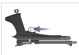
Reinigen Sie die Druckluftwaffe in regelmäßigen Abständen (alle 500 Schuss) mit einer CO<sub>2</sub>-Wartungskapsel. Entfernen Sie alle Diabolos aus der Druckluftwaffe, setzen Sie eine Wartungskapsel ein und schließen Sie das CO<sub>2</sub>-Fach. Halten Sie die Druckluftwaffe wie abgebildet und schießen Sie auf ein sicheres Ziel, bis die Wartungskapsel leer ist.
