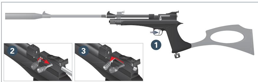
Entsichern Sie die Druckluftwaffe. Um zu schießen, zielen Sie auf ein sicheres Ziel und betätigen den Abzug 1.
