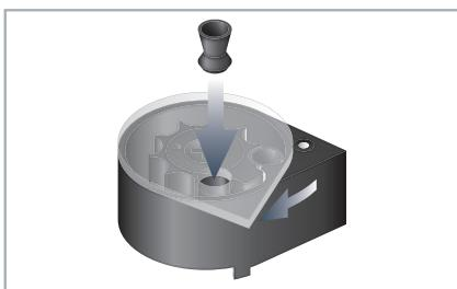
6. Drehen Sie die transparente Platte im Uhrzeigersinn bis die nächste Kammer sichtbar ist und setzen das Diabolo ein.
