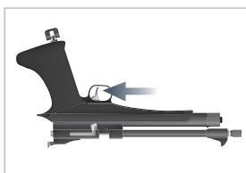
Nettoyez l'arme à air comprimé à intervalles réguliers (tous les 500 tirs) à l'aide d'une capsule d'entretien. Retirez tous les diabolos de l'arme et fermez la chambre à CO<sub>2</sub>. Tenez l'arme comme montré dans la figure et tirez sur une cible sûre jusqu'à ce que la capsule d'entretien soit vide.
