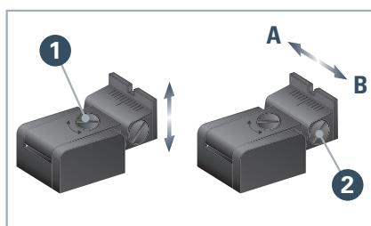
**Ajuste en altura:** Si el punto de impacto es demasiado alto: Gire el tornillo **1** en dirección a las manecillas del reloj. Si el punto de impacto es demasiado bajo: Gire el tornillo **1** en dirección contraria a las manecillas del reloj.
