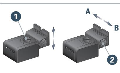
**Réglage en élévation :** Si le point d'impact est trop haut : Tournez la vis **1** dans le sens des aiguilles d'une montre. Si le point d'impact est trop bas : Tournez la vis **1** dans le sens contraire des aiguilles d'une montre.
