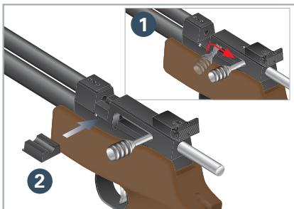
1. Ziehen Sie den Spannhebel hoch und bis zum Einrasten zurück **1**. Setzen Sie wie abgebildet die Ladehilfe ein **2**.
