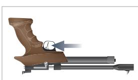
Limpie periódicamente el arma (cada 500 disparos) utilizando una cápsula de mantenimiento. Quite todos los diábolos del arma y cierre la cámara de CO<sub>2</sub>. Mantenga el arma como mostrado en la figura y dispare sobre un blanco seguro hasta que la cápsula de mantenimiento esté vacía.
