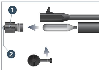
1. Abre el compartimiento de CO<sub>2</sub> (como se muestra en la figura). Si el tapón roscado 1 no se puede aflojar con la mano, utilice la varilla de refuerzo 2 para aflojarlo. **Advertencia**: Al extraer la cápsula de CO<sub>2</sub> vacía, es posible que se escape una pequeña cantidad de gas.
