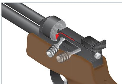
9. Schieben Sie den Spannhebel nach vorne und unten. Laden Sie nie mehr als 1 Diabolo in den Lauf. Es wird empfohlen, nur direkt vor dem Schießen das Diabolo zu laden.
