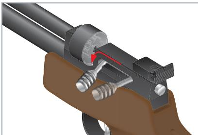
9. Faites passer le levier le verrou [levier d'armement] en avant et vers le bas pour le fermer. **N'introduisez jamais plus d'un diabolo dans le canon. Pour empêcher le chargement de deux diabolos, il est conseillé de n'introduire le diabolo dans le canon que juste avant le tir.**
