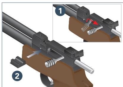
1. Eleve la palanca de amartillado y muévala hacia atrás hasta que encaje para bloquear el cerrojo en la posición abierta
