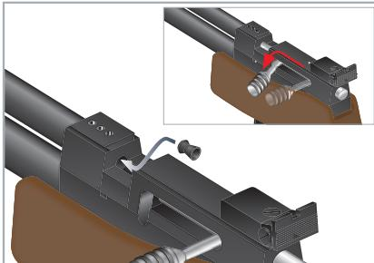
2. Introduisez un diabolo dans le canon (de façon affleurante, comme montré dans la figure), puis faites passer le levier d'armement en avant et vers le bas. **Ne pas** charger plus d'un diabolo à la fois.
