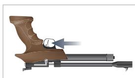
Reinigen Sie die Druckluftwaffe in regelmäßigen Abständen (alle 500 Schuss) mit einer CO<sub>2</sub>-Wartungskapsel. Entfernen Sie alle Diabolos aus der Druckluftwaffe, setzen Sie eine Wartungskapsel ein und schließen Sie das CO<sub>2</sub>-Fach. Halten Sie die Druckluftwaffe wie abgebildet und schießen Sie auf ein sicheres Ziel, bis die Wartungskapsel leer ist.
