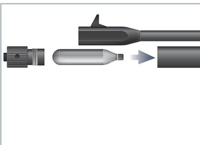
2. Inserte la cápsula de CO<sub>2</sub>, luego cierre el compartimiento de CO<sub>2</sub> con el tapón roscado. Una vez que la cápsula CO<sub>2</sub> esté perforada, asegúrese de apretar el tapón rápidamente para evitar cualquier fuga/pérdida innecesaria de gas.
