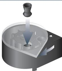
6. Drehen Sie die transparente Platte im Uhrzeigersinn bis die nächste Kammer sichtbar ist und setzen das Diabolo ein.
