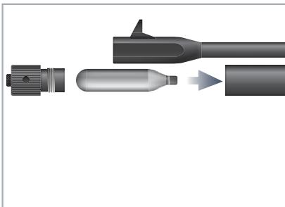
2. Setzen Sie die CO<sub>2</sub>-Kapsel ein und schließen Sie das CO<sub>2</sub>-Fach mit der Verschluss-schraube. Schrauben Sie zügig, sobald die CO<sub>2</sub>-Kapsel angestochen wurde, um unnötigen Gasverlust zu vermeiden.
