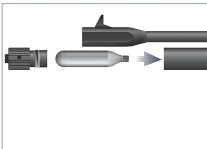
2. Insérez la capsule de CO<sub>2</sub>, puis fermez le compartiment à CO<sub>2</sub> avec le bouchon fileté. Une fois que la capsule de CO<sub>2</sub> est perforée, veillez à serrer le bouchon rapidement pour éviter toute fuite/perte de gaz inutile.
