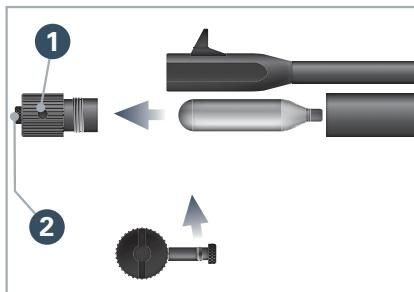
1. Ouvrez le compartiment à CO<sub>2</sub> comme indiqué. Si le bouchon fileté **1** ne peut pas être desserré à la main, utilisez la tige de renfort **2** pour le desserrer.
