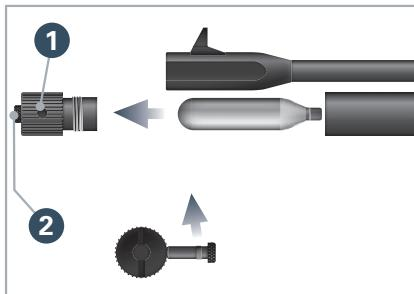
1. Öffnen Sie das CO<sub>2</sub>-Fach wie abgebildet. Wenn sich die Verschluss-kappe 1 nicht mit Handkraft öffnen lässt, verwenden Sie den eingeschraubten Verstärkungspin 2 um die Kappe zu öffnen. **Warnung:** Beim Entfernen der leeren CO<sub>2</sub>-Kapsel kann etwas Gas entweichen.
