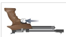
Nettoyez l'arme à air comprimé à intervalles réguliers (tous les 500 tirs) à l'aide d'une capsule d'entretien. Retirez tous les diabolos de l'arme et fermez la chambre à CO<sub>2</sub>. Tenez l'arme comme montré dans la figure et tirez sur une cible sûre jusqu'à ce que la capsule d'entretien soit vide.
