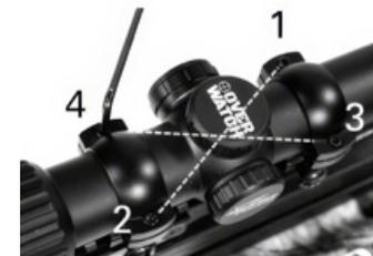
**ATTENTION ! NE SERREZ PAS TROP LES VIS DE LA BAGUE DE LA LUNETTE. UN SERRAGE TROP ÉLEVÉ PEUT ENDOMMAGER LA LUNETTE OU LES BAGUES, AFFECTANT SES PERFORMANCES OU LES RENDANT INUTILISABLES. L'ÉCART ENTRE LES MOITIÉS SUPÉRIEURE ET INFÉRIEURE DE LA BAGUE DOIT ÊTRE RÉGULIER À GAUCHE ET À DROITE DES DEUX BAGUES.**
