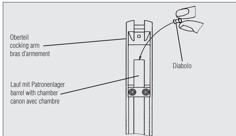
Verwenden Sie **nur** Diabolo-Kugeln und **keine** Stahlbolzen / -pfeile, Rundkugeln oder ähnliches. Achten Sie darauf, dass die Kugeln nicht beschädigt sind. Verwenden Sie keine gebrauchten Kugeln. Beachten Sie das jeweilige Kaliber Ihrer Waffe.
