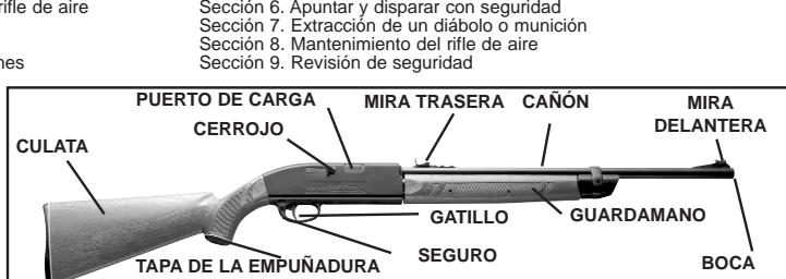
**ADVERTENCIA:** Mantenga el rifle de aire en la posición "ON SAFE" (Seguro activado) hasta que esté totalmente listo para disparar. Luego empuje el seguro a la posición "OFF SAFE" (Seguro desactivado).
